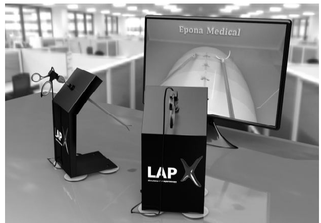
Рис. 1. Лапароскопічний віртуальний симулятор портативного типу (виробник: Epona Medical, Нідерланди).
